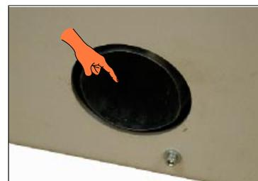
Tube d'aspiration d'un diamètre de 140mm du côté machine
