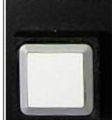
En appuyant sur la touche Fermer blocage pièce table élévatrice (313), les blocages de pièce se ferment.
